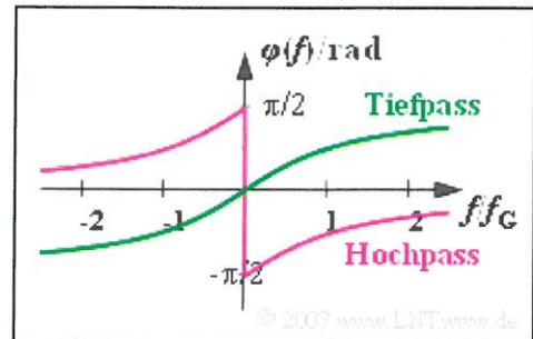
Bei positiven Frequenzen ergibt sich also bis auf eine Verschiebung um  $\pi/2$  nach unten der gleiche Verlauf wie beim TP-System. Da die Phasenfunktion ungerade ist, gibt es bei negativen Frequenzen eine Verschiebung um  $\pi/2$  nach oben. Richtig sind die Lösungsvorschläge 2 und 3.
