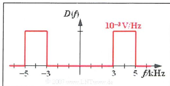
Die Differenz der zwei gleich hohen Rechteckfunktionen führt zu einem rechteckförmigen BP-Spektrum zwischen 3 kHz und 5 kHz. Die (einseitige) Bandbreite beträgt somit  $B_d = \underline{2 \text{ kHz}}$ . In diesem Frequenzintervall ist  $D(f) = 10^{-3} \text{ V/Hz}$ . Außerhalb, also auch bei  $f = 0$ , gilt  $\underline{D(f) = 0}$ .
