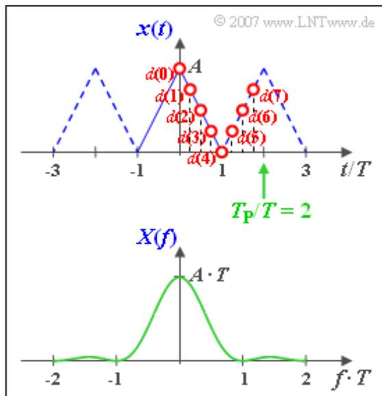
Die Spektralfunktion soll nun durch eine Diskrete Fouriertransformation (DFT) mit  $N = 8$  angenähert werden, wobei die  $N$  Koeffizienten für den Zeitbereich, also  $d(0), \dots, d(7)$ , der Grafik entnommen werden können.
